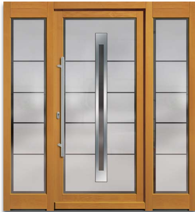
Modell 6272 mit Seitenteil | 3-fach Verglasung: mittlere Scheibe ESG | mattiertes Glas mit klarem Rand, Motiv und Streifen klar Applikation-Edelstahloptik | Griff: Stoßgriff Edelstahl 1000 mm | Tür HB 90
