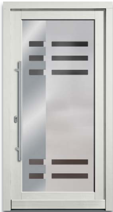
Modell 6267 | 3-fach Verglasung: mittlere Scheibe ESG | mattiertes Glas mit klarem Motiv | Applikation-Edelstahloptik | Griff: Stoßgriff Edelstahl 1000 mm | Tür HB 90
